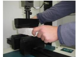
**Aditivo para Collage** → Alta cohesión (Resistencia a la tracción perpendicular)
