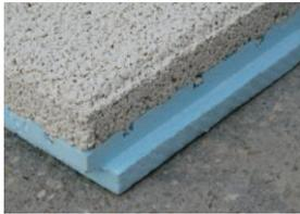
El corte perimetral a media madera muestra excelentes resultados en términos de eliminación de los puentes térmicos y mejora de la eficacia del aislamiento térmico, 12 a 17% superiores a las soluciones de corte recto en el aislamiento (12% para juntas de 1mm y 17% para juntas de 2mm).
